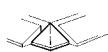
Corner strip Hörnlist Ecke Angle Junta de esquina Angoli terminali Kulmapala 55 x 55 mm (2,2 x 2,2 inches)
